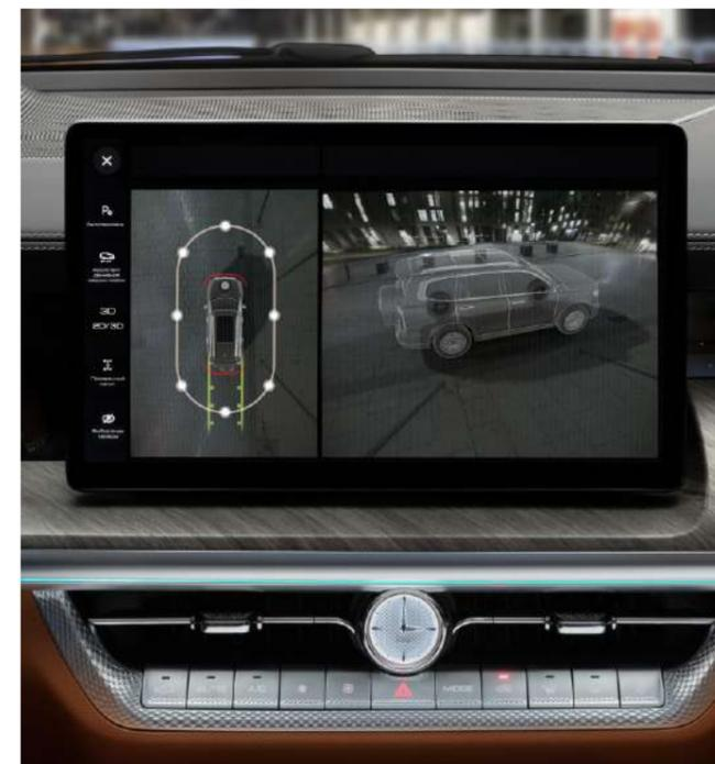
Система камер кругового обзора с функцией «прозрачного» капота
