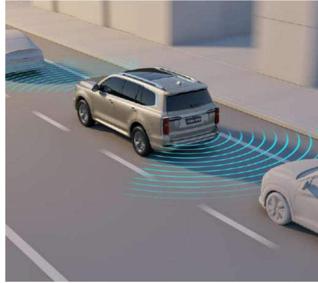
Автоматическая функция торможения (АЕВ) с функцией предупреждения о возможном столкновении при движении вперед (FCW) и функцией распознавания пешеходов
